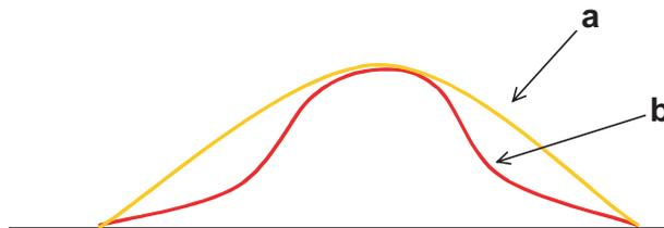
**Figure 6.** ALTERATION TO THE DOME TO PRODUCE A SMOOTH TRANSITION INTO THE GRID AT ANGLES AWAY FROM THE PATH. A) CROSS SECTION ALONG THE PATH (HALF OF A SINE WAVELENGTH). B) CROSS SECTION AWAY FROM THE PATH (COSINE TAPERS JOINED BACK-TO-BACK).
